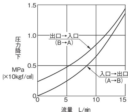
(ガスケット取付形のサブブロックを装着して測定した値です。)
