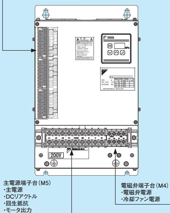
※主電源の結線:電源端子(L1、L2、L3)に3φ、AC200/200/220V、50/60/60Hzを結線し、アース接続部にアースを結線してください。
