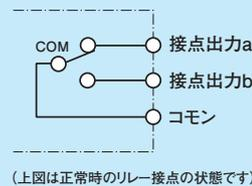
※接点出力の容量は開閉容量 DC30V/0.5A(抵抗負荷)です。
