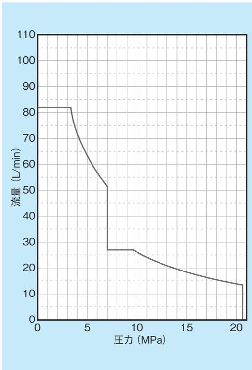
※最高圧力での連続使用は、流量14L/min以下でご使用ください。
