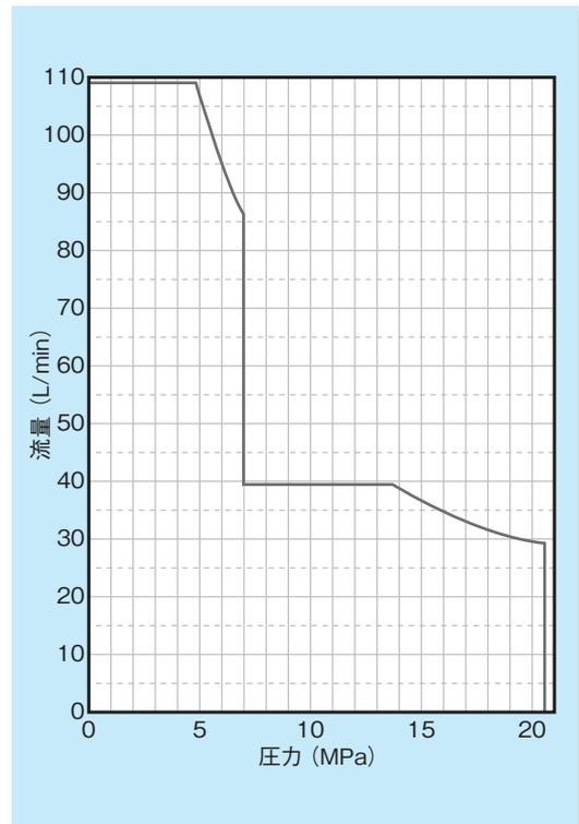
※最高圧力での連続使用は、流量16L/min以下でご使用ください。
