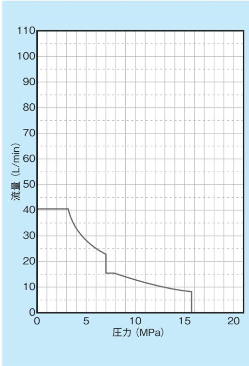
※最高圧力での連続使用は、流量8L/min以下でご使用ください。
