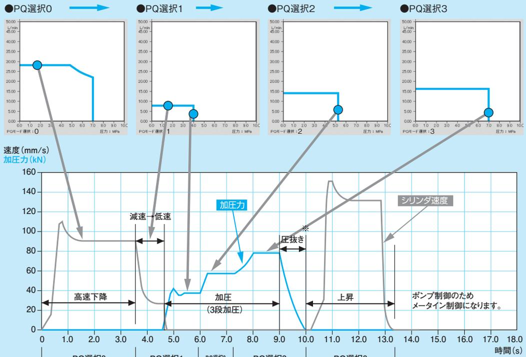
※圧抜き制御停止の状態では別途負荷側に圧抜き回路を設けて行ってください。
