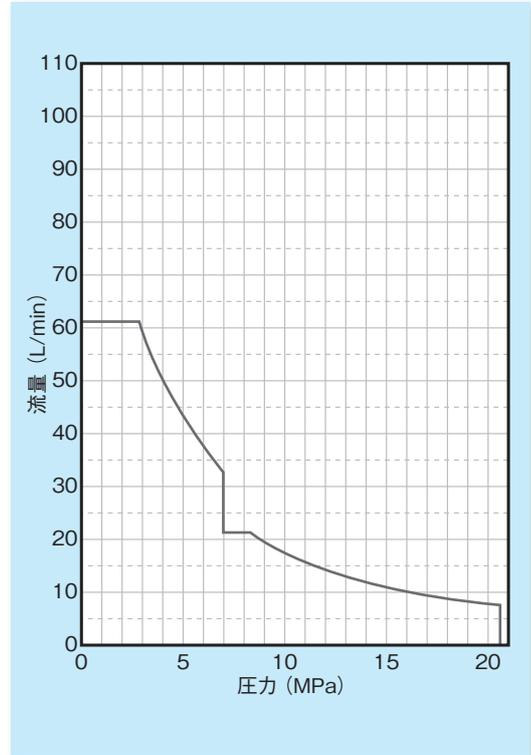
※最高圧力での連続使用は、流量6.5L/min以下でご使用ください。
